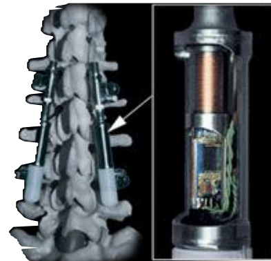
Instrumentierter Wirbel-Fixateur Vergrößerung: Messhülse mit Belastungssensoren
